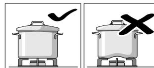
Nepoužívejte zdeformované nádoby, které nestojí na varné desce stabilně. Hrnce se mohou převrhnout.
