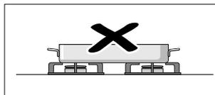
Niedopuszczalne jest podgrzewanie naczyń (np. brytfanny, patelni lub kamiennych płyt do grillowania) jednocześnie przez więcej niż jeden palnik. Powstająca w ten sposób kumulacja ciepła może uszkodzić urządzenie.
