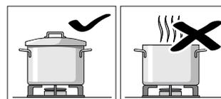
Nevařte bez pokličky nebo s posunutou pokličkou. Proplytvá se tím větší část energie.
