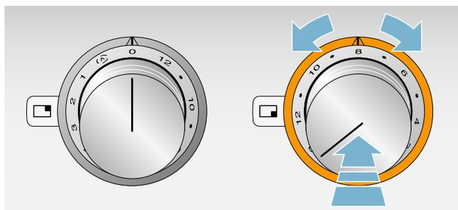
Otáčením ovládacího knoflíku můžete nastavit stupeň vaření.
