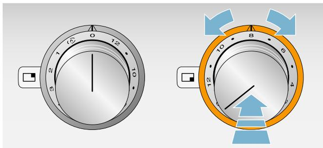
Поворачивая регулятор, можно установить ступень нагрева конфорки.
