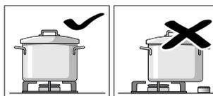
Naczynie do gotowania stawiać na środku palnika, inaczej może się ono przewrócić
