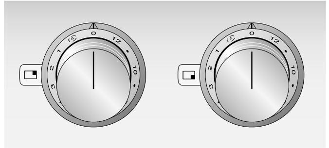
Kumanda düğmesi üzerindeki işaretler, ilgili brülörün hangisi olduğunu gösterir ve bu düğmelerle 1 ile 12 arası pişirme kademeleri veya yavaş kaynatma seviyesi (flame) ayarlanır.
