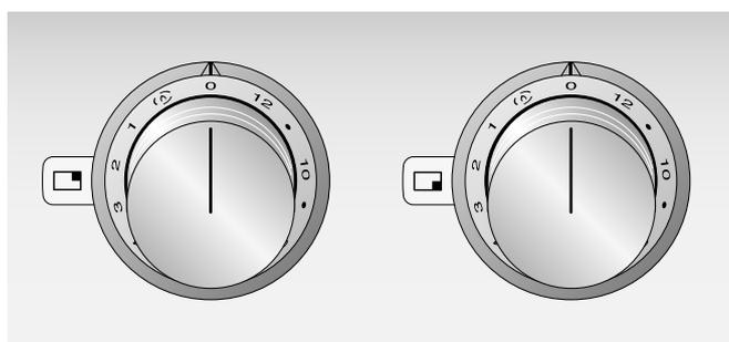
Značky u ovládacích knoflíků označují přiřazení k příslušnému hořáku a nastavení stupně vaření 1 až 12 nebo stupně pro vaření pod bodem varu (H).
