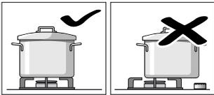
Устанавливайте варочную емкость посередине над горелкой, иначе возможно опрокидывание.
