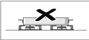
Nikdy neohřívejte nádobu na vaření (např. pekáč, pánve, kamenná grilovací deska) několika hořáky. Akumulací vysokých teplot se poškodí přístroj.
