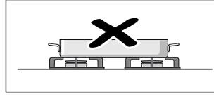
Piştirme kaplarını (örneğin kızartma kabı, tava, grill taşı) kesinlikle birden fazla brülörle ısıtmayın. Oluşan ısı yığılması cihazda hasarlara yol açar.
