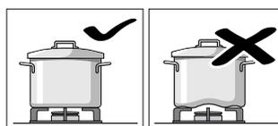
Не пользуйтесь деформированными варочными емкостями, так как они не обладают устойчивостью при установке на конфорку. Такие емкости могут опрокидываться.
