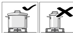
Используйте варочные емкости подходящего размера для соответствующей горелки.
